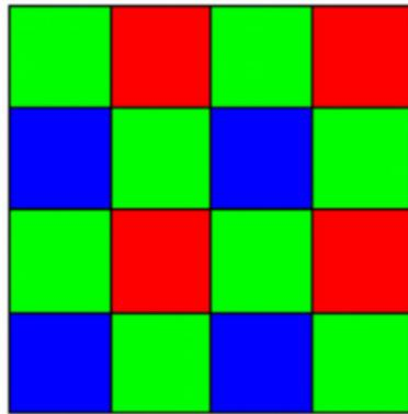
Disposition des filtres sur les photosites
