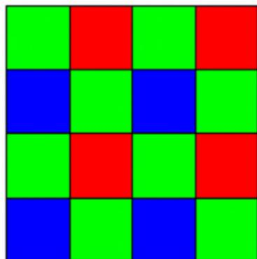
Disposition des filtres sur les photosites
