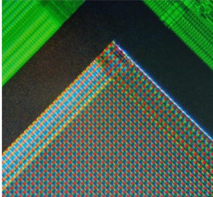
Capteur photo d'une webcam
